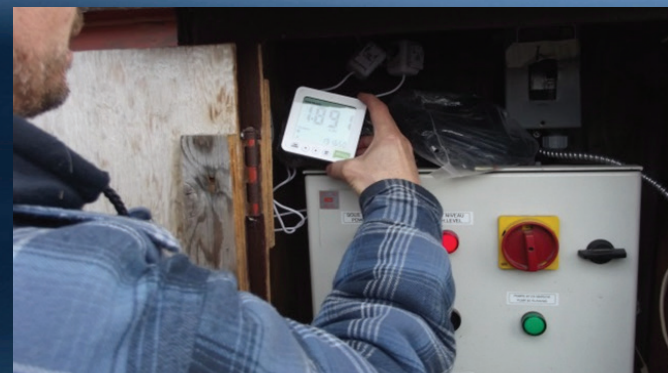
FIGURE 1B: ENREGISTREMENT DU PROFIL DE CHARGE RÉEL
